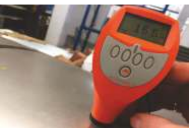
Controllo spessore di ricopertura
