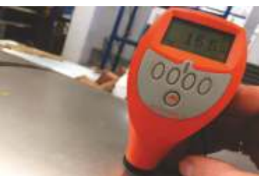
Controllo spessore di ricopertura
